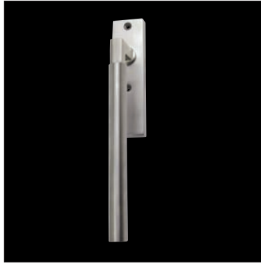
Hebeschiebetürgriff passend zur Linie Walter Gropius, Grifflänge 230 mm, mit 90° Rasterung auf eckiger Grundplatte, Verschraubung Distanz 80 mm, Stift 10x60 mm
